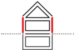
Eine Wärmedämmung der Außenwände wird häufig an der Außenseite aufgebracht. Die Gefahr von Wärmebrücken, die zu Energieverlusten, aber auch Bauschäden führen, wird mit einer vollflächigen Außenwanddämmung weitgehend unterbunden. Bei denkmalgeschützten Gebäuden scheidet diese Möglichkeit jedoch oft aus.
