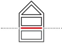
Die Dämmung der Kellerdeckenunterseite ist eine der einfachsten und wirtschaftlichsten Maßnahmen zur Reduzierung von Wärmeverlusten. Die Dämmstärke wird von Raum- und Türhöhen und eventuell vorhandenen Leitungsführungen begrenzt. Bei Gewölbekellern ist eine unterseitige Dämmung nur eingeschränkt möglich.
